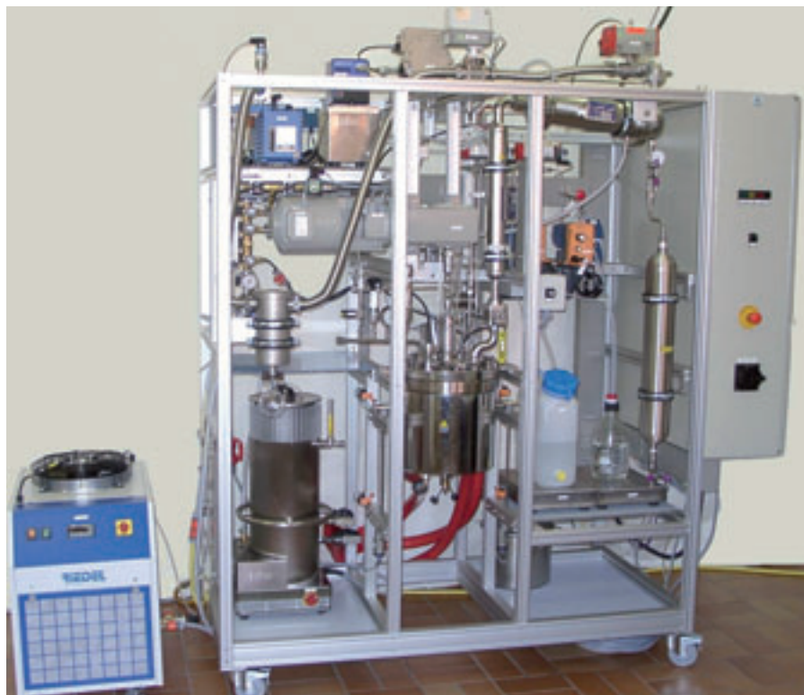
10-litre polymerisation plant
