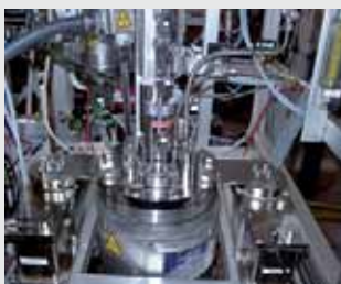
Deckel eines 2-l-Reaktors auf kompensierten Wägezellen
