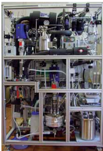
Fertige Anlage B x T x H = 1130 x 570 x 1680 mm
