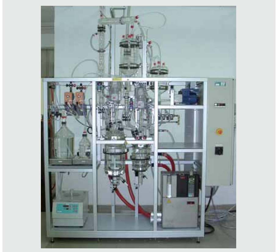
Glasanlage mit 2 Reaktoren, Dosierung, Destillationsteil und Zentrifuge
