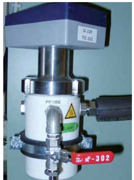
Leitfähigkeitsmessbehälter aus PTFE
