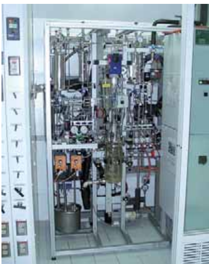
Rührkesselanlage, Glas 3 Liter, 3 bar
