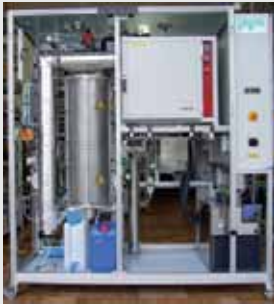
Katalysator-Testeinheit mit zwei Reaktoren, 750 °C, 40 bar
