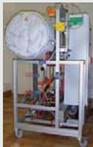
Extraktions- und Trockeneinheit für Kunststoffpellets
