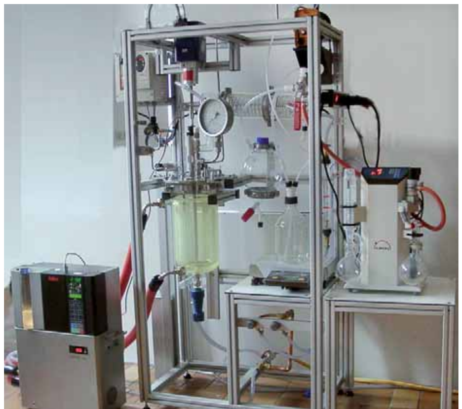
Glasanlage mit Einzelreglern, 5 Liter, 300 °C
