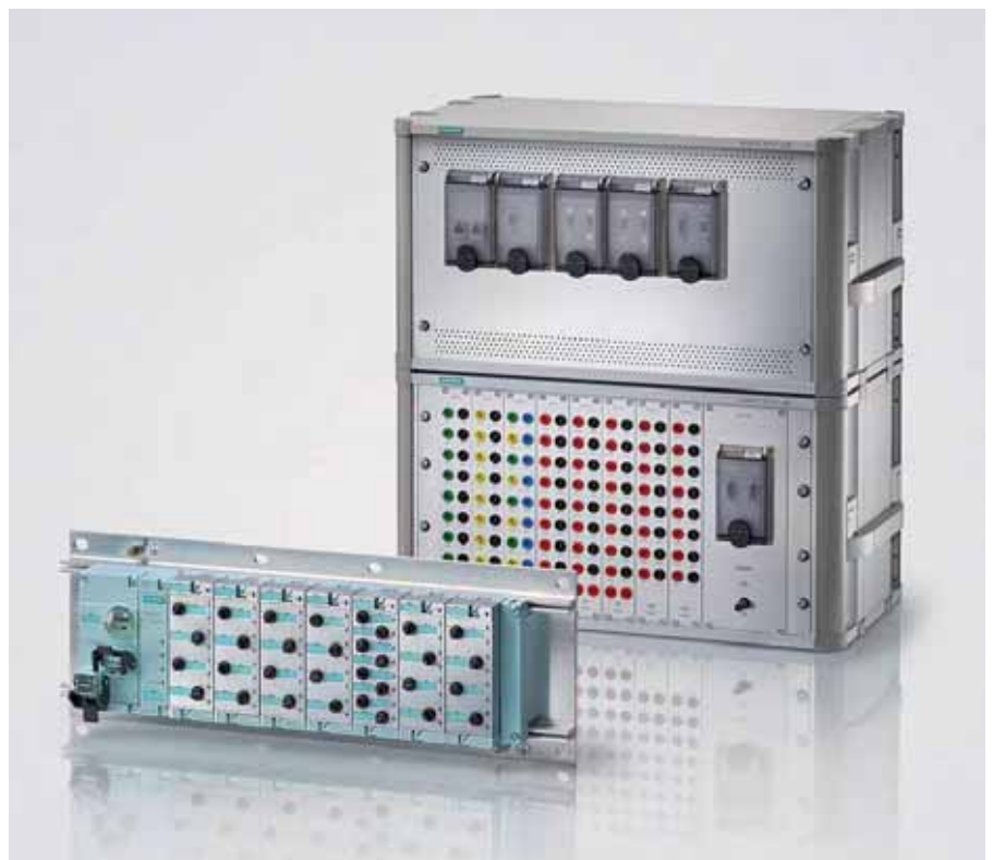
Plug & Play – Simatic PCS7 Lab mit Steckanschlüssen
