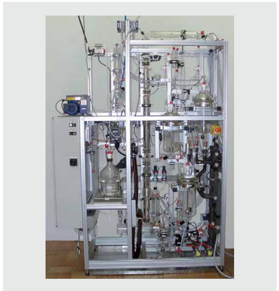
Automatisierte kontinuierliche Rektifikationsanlage mit Ø 30mm Sulzer-Packung™, mit Phasenabscheider, komplett mit allen notwendigen Messungen, Pumpen und Ventilen. B x T x H = 1500 x 800 x 2300 mm
