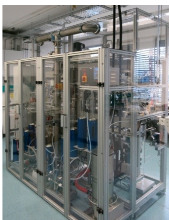
Rückseite der Anlage mit Vakuumsystem
